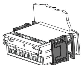
Instalação com parafusos (a esquerda), ou com presilhas (a direita)
