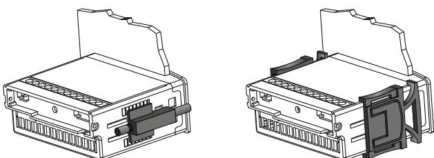
Instalação com parafusos (a esquerda), ou com presilhas (a direita)
