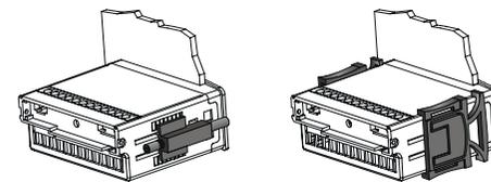
Instalação com parafuso de fixação (a esquerda) ou sob encomenda com presilha (a direita).
