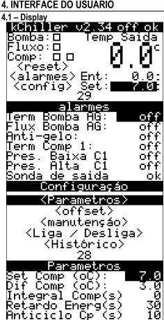
Na tela principal é possível verificar status das bombas de circulação de água gelada, status do fluxo de água nos circuitos e status dos dois compressores. Se pode também visualizar a temperatura de saída e de entrada da água, além de alterar o setpoint de controle. Com as teclas  $\wedge$  e  $\vee$ , é possível navegar entre as opções Set, reset, alarmes e configuração. Na parte superior são apresentadas o status do equipamento (On/Off e OK/AL – alarme).
